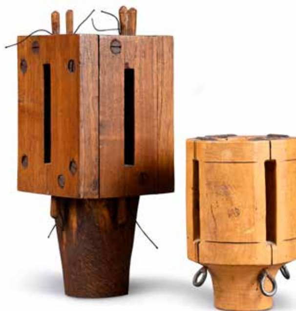
336. Ensemble de deux équerres d'arpenteur à bois pour vigneron, XIX e siècle. Bois et fer ; 20 x 11 cm et 11 x 7,8 cm. Une grande équerre de forme carrée à tasseaux de bois servant à maintenir les fils de visée, la seconde de forme cylindrique. Ces équerres de construction assez artisanale ou rustique, proches de productions d'art populaire, servaient, semble-t-il, à la plantation des vignes. 120 / 150 €
