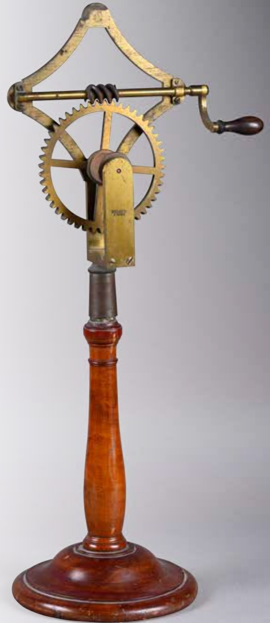
111. Modèle de transmission à vis sans fin, signé «Deleuil à Paris», circa 1850. laiton et bois ; H. 56 cm. Bien que plus tardif, ce mouvement de vis sans fin est un héritage direct des expériences de l'Abbé Nollet. 200 / 300 €
