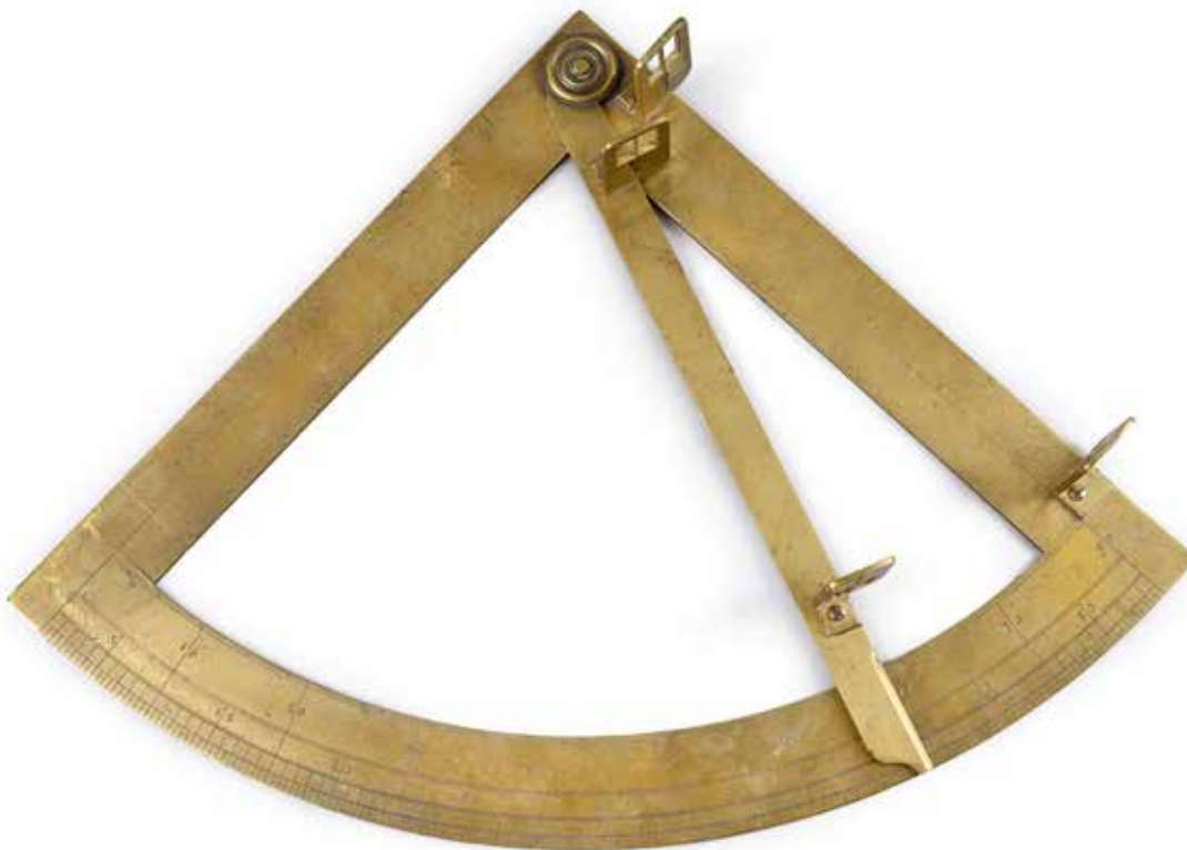
330. Quart de cercle à deux pinnules et une alidade mobile, signé Nicolas Bion à Paris, circa 1700. Laiton ; rayon : 27 cm. Bion en décrit longuement la construction et l'usage dans son Traité de la construction et des principaux usages des instrumens de mathématique , 1709, pages 139 à 153, planche 13, figure G. Son utilisation peut être
