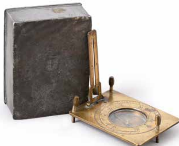
79. Cadran solaire chinois , XIX e siècle. laiton ; 8,5 x 6,2 cm. Modèle à fil-axe et à potence monté sur trois vis calantes. Manque le gnomon et le fil. Conservé dans sa boîte d'origine en étain portant le cachet du fabricant, non identifié : 德泉游造. 200 / 300 €
