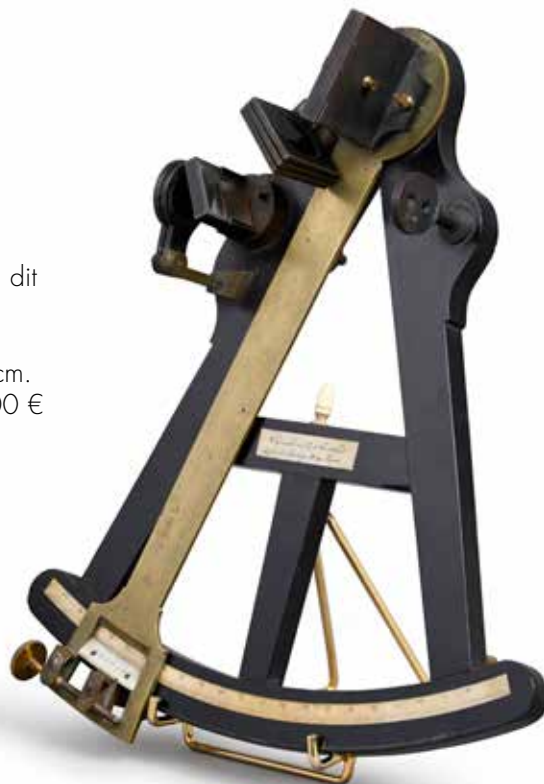
24. Octant de marine signé «Vincent et Charles Chevalier Quai de l'Horloge n° 69 à Paris», circa 1825-1830. Ebène, laiton et ivoire ; H . 25 cm. Règle, signature, vernier et gland décoratif en ivoire. Miroirs et filtres en bon état et complets. Signature rare sur un octant des Chevalier père et fils. 300 / 500 €
