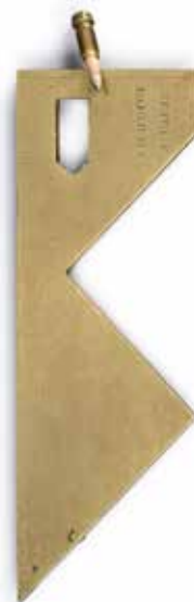
301. Peu courante forme d'équerre, règle et niveau inscrite en demy pied du roy et demy pied de Rhin, signée Chapotot à Paris, circa 1700. Laiton ; 17 x 6,5 cm. Une partie se compose de deux angles à 90 degrés. Petit emplacement dévissable pour crayon dans la base de l'instrument. 300 / 400 €
