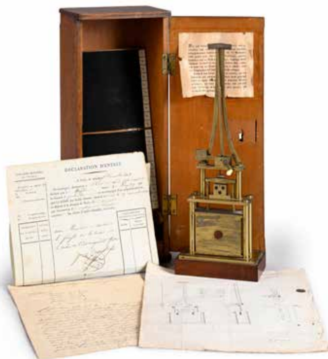
219. Instrument pour mesurer la grosseur des brins de laine ou machine à mesurer la finesse de la laine , Allemagne, circa 1823. laiton et acier ; H . 33 cm (mécanisme partiellement rouillé). Petite machine pour tester les fils de laine importée d'Allemagne en 1824 par Ternaux et fils. L'instrument permet de tester les différents types de fils afin d'en faire le meilleur usage possible : drap, étoffe, tapis, etc. Le présent exemplaire est celui qui fut importé d'Allemagne par Ternaux en 1824 (documents d'importation originaux joints) et qui fit l'objet d'un compte-rendu par Hachette dans le Bulletin de la Société d'encouragement en juillet 1826 (photocopie de l'article jointe). La machine est conservée dans sa boîte de transport, avec sa «déclaration d'entrée» produite par les douanes royales de France le 29 novembre 1824. 100 / 200 €
