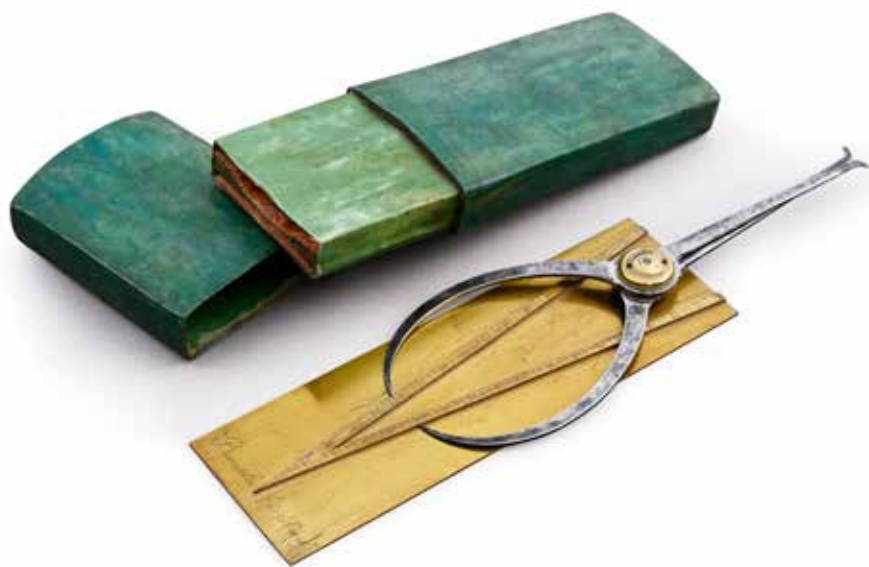
300. Compas maître à danser et sa mesure d'ouverture par «Baradelle fils à Paris», fin du XVIII e siècle. Laiton et acier, étui d'origine en galuchat vert. Longueur du compas : 18,5 cm. Rare compas d'épaisseur de forme maître à danser, ayant conservé sa mesure d'ouverture donnant immédiatement la mesure de l'écartement. 300 / 500 €
