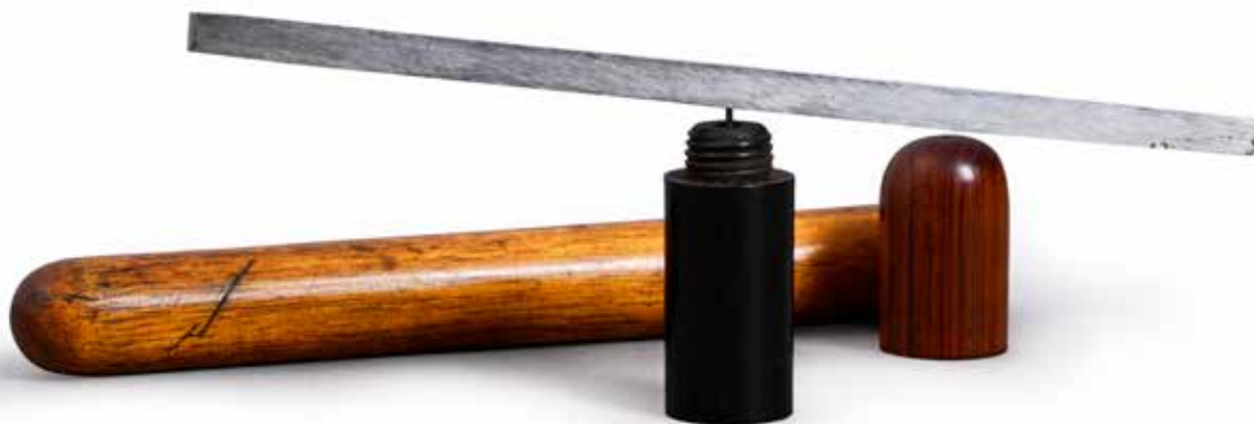
70. Aimant démontable dans son étui en bois, reposant sur une aiguille incorporée dans le bouchon, utilisée pour l'étude et la détermination des minéraux ferreux, XIX e siècle. L. 16 cm. 80 / 120 €
