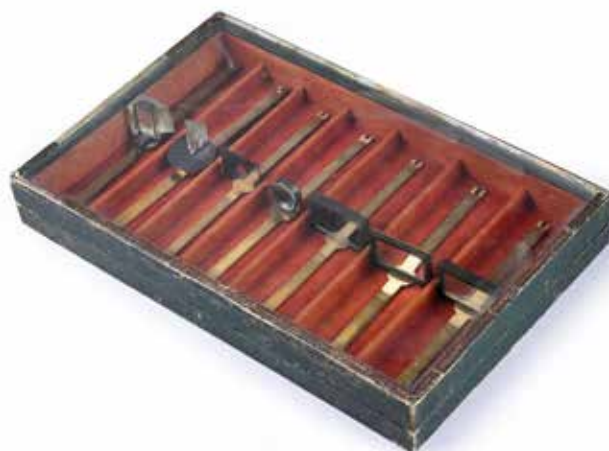
232. Appareil de Silbermann signé «J. Duboscq à Paris», avec sa très rare boîte d'accessoires signée par Soleil à Paris, circa 1850 / 1860. Laiton, verre et acier ; H. 42 cm ; diamètre du cercle : 25 cm. L'appareil de Silbermann est un instrument d'optique permettant de démontrer les lois de la réfraction. Très rare avec sa boîte de sept accessoires comprenant divers miroirs et prismes. 800 / 1 000 €
