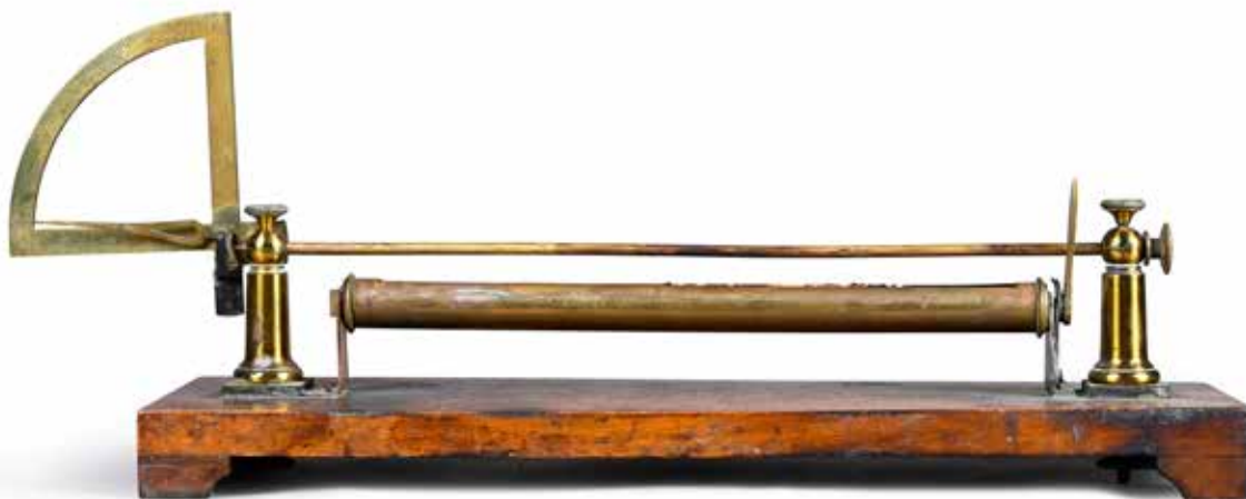
230. Pyromètre à levier signé «Pixii père et fils à Paris», circa 1830 / 1840. Bois, laiton, verre et fer ; longueur totale : 55 cm. Modèle classique servant à mesurer la dilatation linéaire des solides sous l'action de la chaleur. 150 / 200 €
