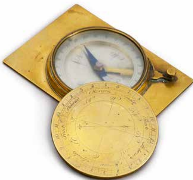
69. Boussole des mines , modèle dit Setz-Kompass d'après Nicolaus Voigtel, Allemagne, circa 1770. Laiton, laiton argenté et acier ; base rectangulaire : 9,5 x 7,8 cm. Un modèle avec les mêmes mentions de minerais est illustré dans le Theatri Machinarvm Svpplementvm de Leupold de 1774, planche 20. Sur le couvercle, les noms indiquent des gisements de minerais. Bon état. 150 / 200 €
