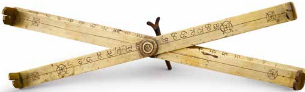
329. Sauterelle ou équerre d'arpenteur , France ?, première moitié du XVII e siècle. Laiton ; longueur fermée : 24,3 cm. Bien que de fabrication presque artisanale, cette équerre pliable est de datation particulièrement précoce, certainement avant 1650. Un bras est divisé de 0 à 85, un autre de 0 à 100. Petit décor de rose répété six fois. 200 / 300 €
