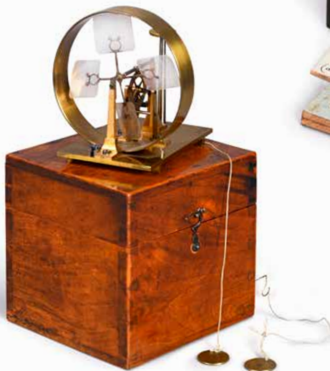
73. Anémomètre de mine , modèle de Combes, en laiton et acier avec pales en mica, France, fin du XIX e siècle. Diam : 8,2 cm. Numéro 114. Complet et dans son coffret d'origine. 300 / 400 €
