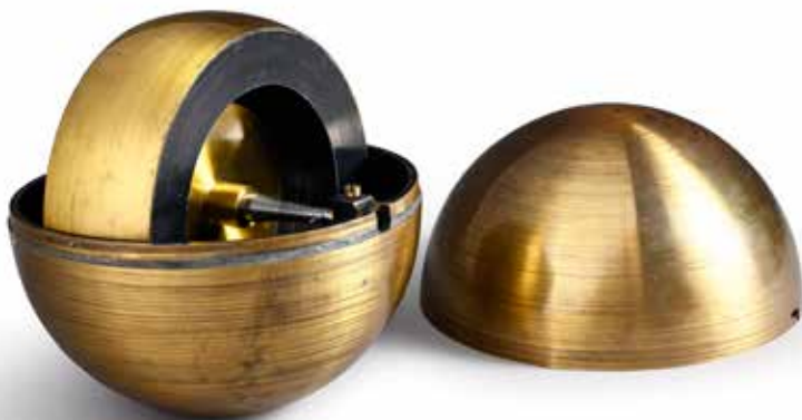
16. Gyroscope sphérique ou toupie d'après Karl Schmidt de Dresde, non signé, Allemagne, fin du XIX e siècle. laiton et fonte ; Diam : 17 cm, poids : environ 6 kg. Dans le catalogue de Max Kolh de 1905, l'instrument est décrit comme : «Toupie de Schmidt avec sphère en tôle et son support. On place la toupie dans une des hémisphères et on lui donne un mouvement de rotation très rapide [...], puis on complète la sphère. Si l'on essaie alors de faire tourner celle-ci pour l'amener dans un autre plan, on éprouve une résistance, comme si l'axe de la toupie était maintenu en place par des forces invisibles». 200 / 300 €
