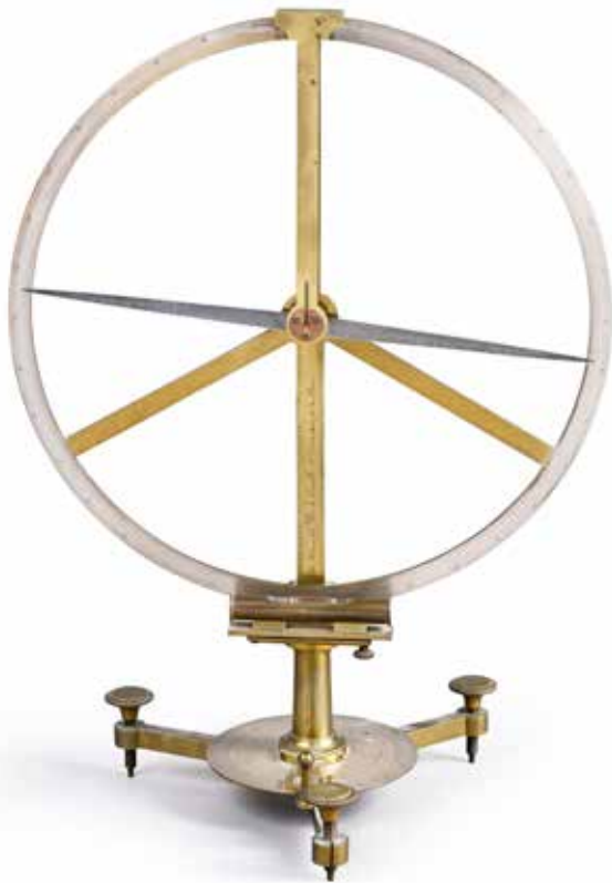
225. Grande boussole d'inclinaison signée «Pixii père et fils rue de Grenelle St. Germain 18 à Paris», circa 1810-1820.
