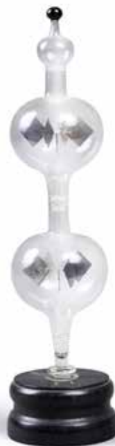
239. Radiomètre de Crookes à deux ampoules, circa 1900. Verre ; H . 27 cm. Intéressant modèle à deux ampoules, quatre et deux ailettes. Le radiomètre permet de détecter et mesurer les rayonnements électromagnétiques. 150 / 200 €
