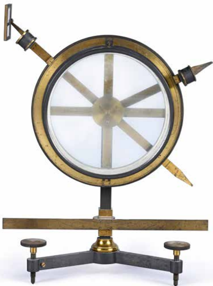
232. Appareil de Silbermann signé «J. Duboscq à Paris», avec sa très rare boîte d'accessoires signée par Soleil à Paris, circa 1850 / 1860. Laiton, verre et acier ; H. 42 cm ; diamètre du cercle : 25 cm. L'appareil de Silbermann est un instrument d'optique permettant de démontrer les lois de la réfraction. Très rare avec sa boîte de sept accessoires comprenant divers miroirs et prismes. 800 / 1 000 €
