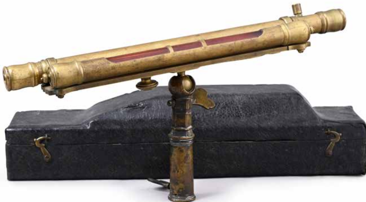
327. Niveau à eau d'arpentage à deux pinnules, signé Chapotot à Paris, circa 1700. Laiton et verre (eau manquante) ; L. 30 cm. L'instrument est complet de sa rotule et de son cache de protection. Grande et belle signature de Chapotot. 200 / 300 €
