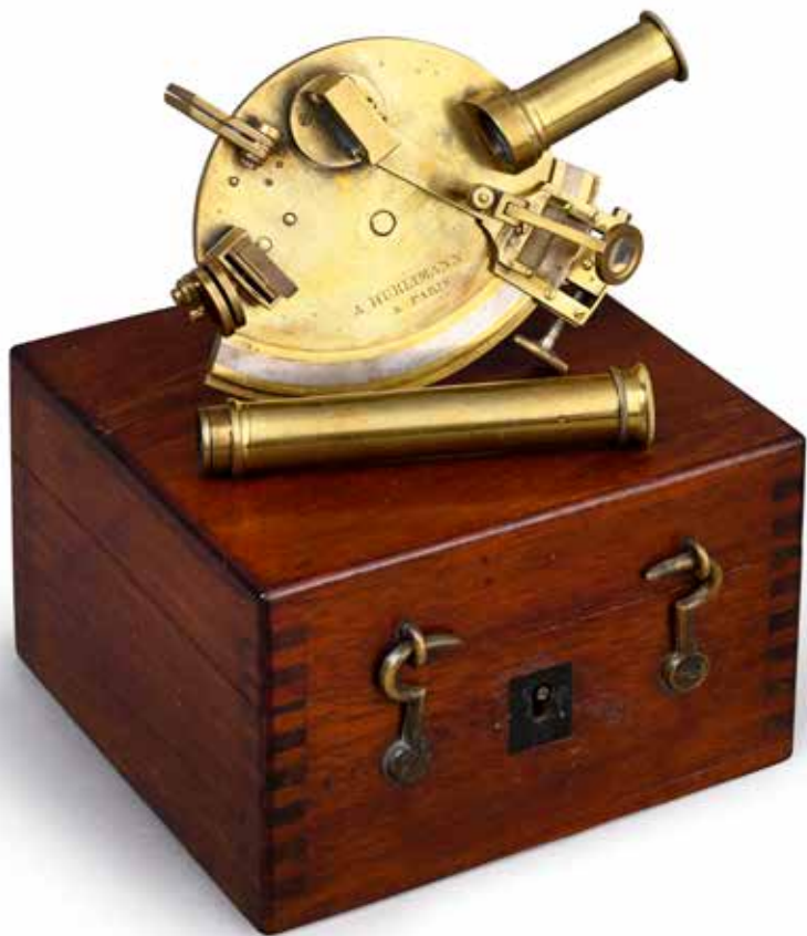
17. Sextant miniature de marine signé «A. Hurlimann à Paris», circa 1880 / 1890. Laiton et laiton argenté ; 9 x 8,5 cm. Boîte en acajou d'origine : 12 x 11,5 x 8 cm. Intéressant modèle pour sa platine de forme circulaire. L'instrument a conservé deux optiques et est complet de ses miroirs et ses filtres solaires. Polissage ancien.
