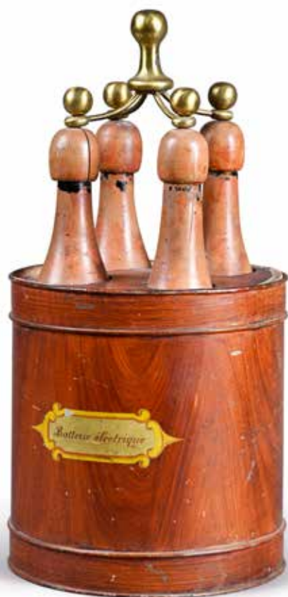
86. Exceptionnelle «batterie électrique» formée de 4 bouteilles de Leyde en forme de bouteilles de champagne dans un récipient en tôle peinte avec inscription, début du XIX e siècle. Verre, laiton, tôle ; H . 45 cm ; Diam : 22,5 cm. 600 / 800 €
