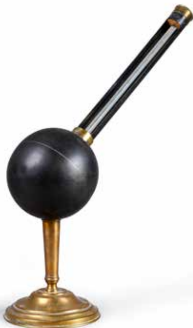
237. Héliothermomètre d'après M. J. Vallot, construit par V. Doninelli à Nice, début XX e siècle. Laiton, fonte et verre ; Diam : 8 cm ; H . 30 cm. Cet instrument, de forme très élégante, sert à donner la mesure approximative de la température sous une étoffe noire, ou sous une tente, exposée au Soleil. 150 / 200 €
