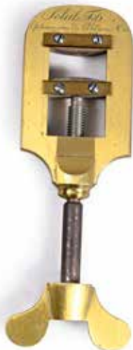
236. Presse pour comprimer le verre par Soleil fils Opticien rue de l'Odéon n° 35, Paris, circa 1840. Laiton et acier ; H . environ 14,5 cm. Instrument servant à l'étude des franges de Newton visibles lors de l'écrasement du verre sous la presse. 80 / 120 €
