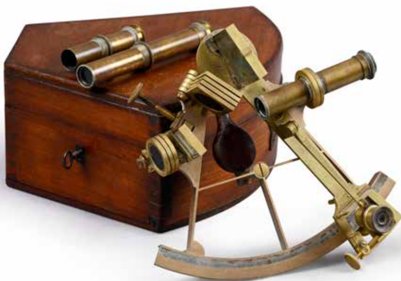
42. Sextant de marine signé «Charles Chevalier Ingénieur Opticien Breveté Palais Royal 163 à Paris», circa 1840. Laiton, poignée d'acajou ; rayon : 15 cm. Bon exemplaire avec ses trois optiques, ses miroirs et ses sept filtres, dans son coffret à la forme en acajou. Polissage ancien ayant laissé des traces de blanc de meudon. 150 / 200 €
