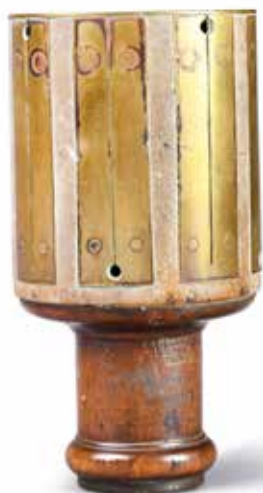
335. Équerre d'arpenteur cylindrique à huit fentes, signée Castex-Blersy à Toulouse, circa 1830. Bois et laiton ; Diam : 7,6 cm ; H : 14,6 cm. Le fabricant de cet instrument, M. Castex-Blersy, apparaît dans le Journal de Toulouse en 1850 et 1852 pour l'invention d'un fouloir pour la vendange. Il est sans doute le successeur de la famille de mécaniciens Castex, établie à Toulouse depuis la fin du XVIII e siècle. 100 / 150 €
