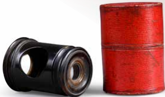
346. Polémoscope ou «lunette de jalousie», France, début du XIX e siècle. Corne ; L. 4,7 cm. Etui d'origine en maroquin rouge. Petite lunette permettant de regarder, discrètement, les objets cachés à notre vision directe. Bel état. Un fêle au verre du côté aveugle. 200 / 300 €
