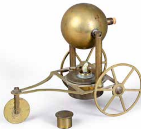
93. Rare éolipile de forme chariot selon l'Abbé Nollet, France, XVIII e siècle. Laiton ; 20 x 16 cm. Cet instrument sert à mettre en évidence la force motrice de la vapeur d'eau. 300 / 500 €
