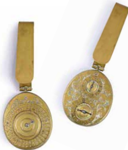
80. Podomètre japonais , XIX e siècle, d'après le modèle introduit vers 1770 par Hiraga Gennai. laiton ; 6,5 x 5,5 cm. Sur la face supérieure figurent un cadran de 60 ken et un second cadran de 10 ri ; la seconde face porte un grand cadran de 36 cho, l'instrument pouvant être utilisé pour une distance maximale de 10 ri soit 39,27 km. Mécanisme non vérifié ; avec sa languette de transport. 200 / 300 €
